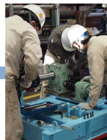
駆動、遊動フレームに減速機、昇降モータ組込
